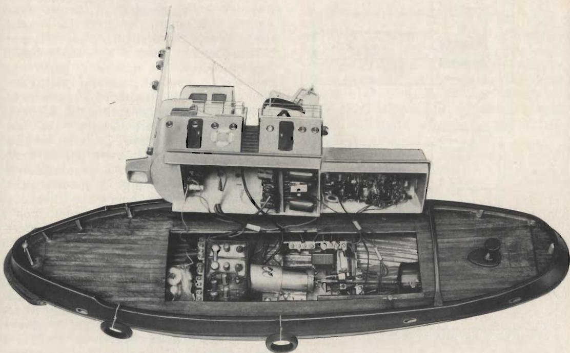
Fig. 1 - La vista « aperta » del battello permette di apprezzare la disposizione compatta e funzionale dei diversi blocchi circuitali.
